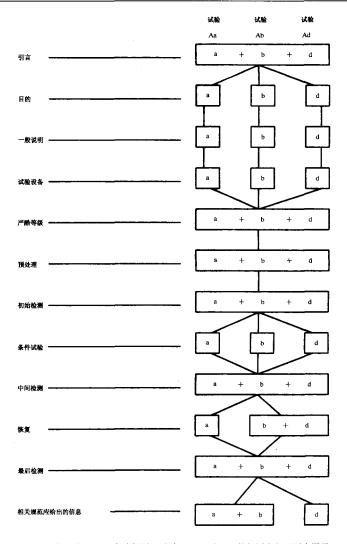
图 2 试验 A:低温试验方法框图 试验 Aa、Ab 和 Ad 的相同点与不同点图示
