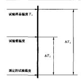
第二阶段:试验样品加负载,在有强迫空气循环的试验箱中试验,对试验样品温度进行监控(ΔT<sub>2</sub>必须是小的,测量试验箱(室)温度按 GB/T 2421—1999 第 4 章的定义要求进行。
