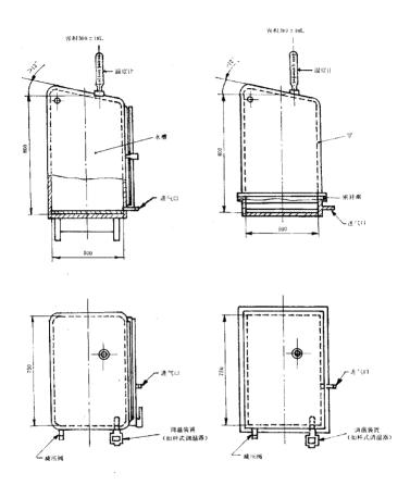
图 1 门式试验箱 注: 如果容积不是300±10 L 的试验箱,只要试样所经受的试验条件一样,仍可使用。本标准所规定的一些绷节仅说 明适用于300±10 L 容积的试验箱,对于其他一些容积的试验箱,这些细节要作相应的修改。
